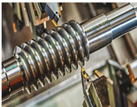
Рис. 85. Образование резьбы
