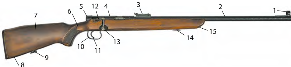
Мал. 113. Малакаліберная вінтоўка ТОЗ-8: 1 — намушнік; 2 — ствол; 3 — прыцэл; 4 — ствольная каробка; 5 — каўпачок (тыльнае вечка); 6 — шыйка ложа; 7 — ложа; 8 — прыклад; 9 — ніжняя антабка; 10 — спускавая скаба; 11 — спускавы кручок; 12 — затвор; 13 — ручка затвора; 14 — верхняя антабка; 15 — цаўё ложа
