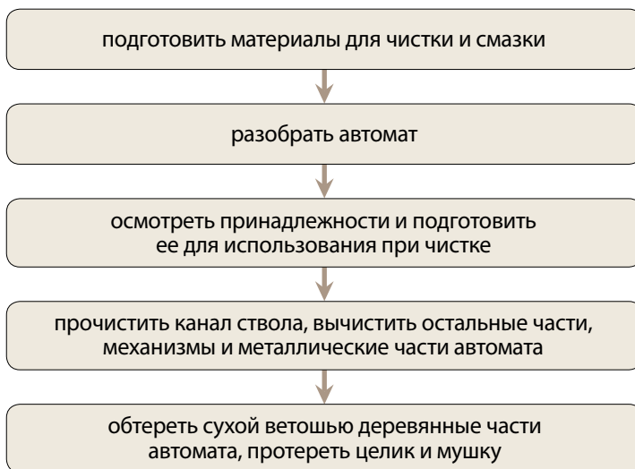
Рис. 119. Основные операции при чистке и смазке автомата
