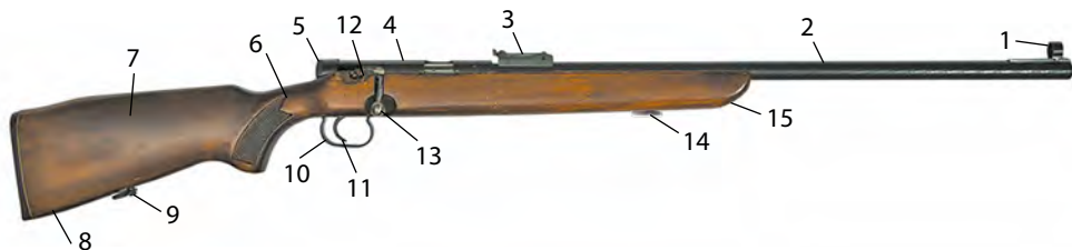
Рис. 113. Малокалиберная винтовка ТОЗ-8: 1 — намушник; 2 — ствол; 3 — прицел; 4 — ствольная коробка; 5 — колпачок (тыльная крышка); 6 — шейка ложи; 7 — ложа; 8 — приклад; 9 — нижняя антабка; 10 — спусковая скоба; 11 — спусковой крючок; 12 — затвор; 13 — рукоятка затвора; 14 — верхняя антабка; 15 — цевье ложи
