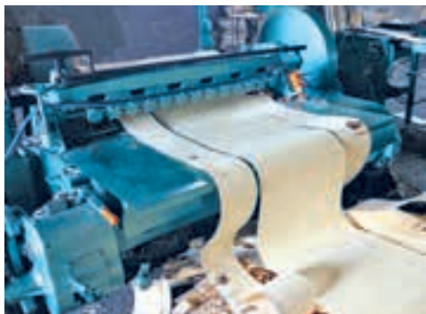
Мал. 160. Выкарыстанне лущыльнага станка (Германія) для вытворчасці мэблевага шпону
