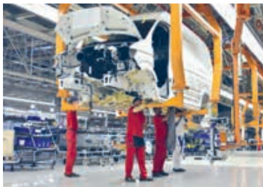
Мал. 165. Канвеерная зборка легкавых аўтамабіляў у Познані (Польшча)
