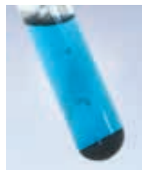
Рис. 33.1. Растворение оксида меди(II) в уксусной кислоте
