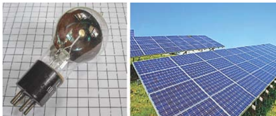
Мал. 177. Фотаэлемент: а — вакуумны (газанапоўнены); б — паўправадніковы
