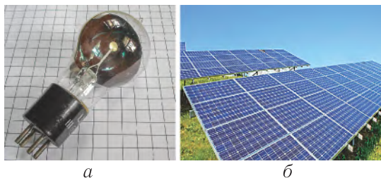
Рис. 177. Фотоэлемент: а — вакуумный (газонаполненный); б — полупроводниковый
