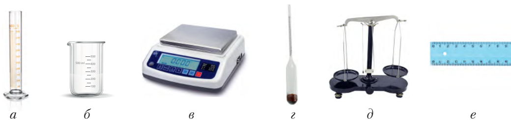
Рис. 9. Лабораторное оборудование для измерений:
