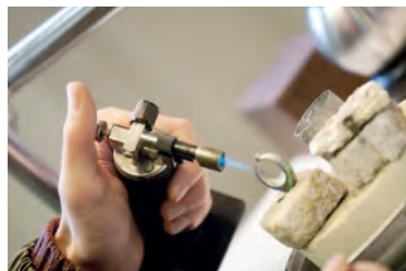
Рис. 66. Сварка ювелирных изделий кислородно-водородным пламенем
