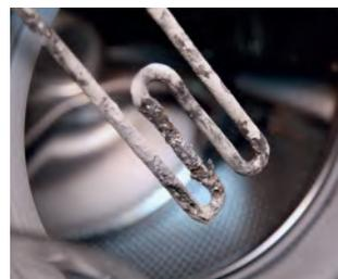
Рис. 112. Накипь на обогревательном элементе стиральной машины
