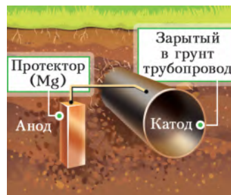
Рис. 116. Защита от коррозии подземного стального трубопровода
