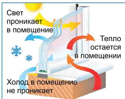
Рис. 72. Воздух между стеклами позволяет сохранить тепло
