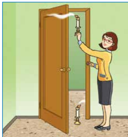
Рис. 77. Перемещение воздуха в дверном проеме
