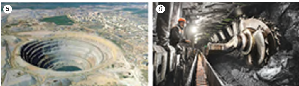
Мал. 32. Здабыча карысных выкапняў: а) адкрытым спосабам (алмазны кар’ер «Мір» у Якуціі), б) закрытым спосабам (вугальная шахта ў Кузбасе)
