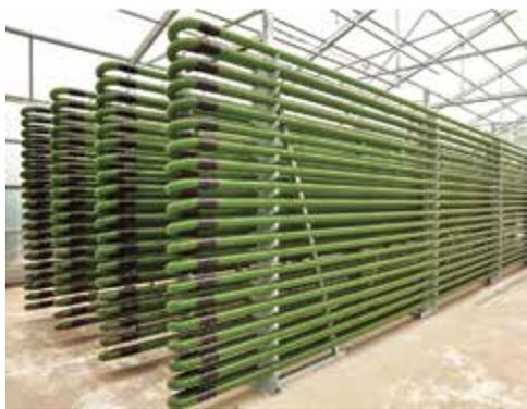
Рис. 36. Установка для выращивания хлореллы
