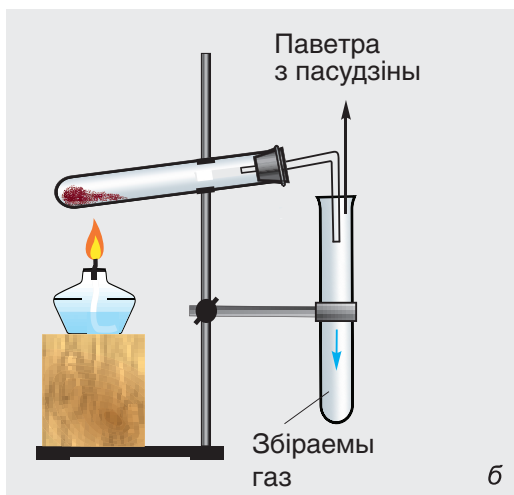
Мал. 45. Схема ўстаноўкі для збірання газаў метадам выцяснення паветра
