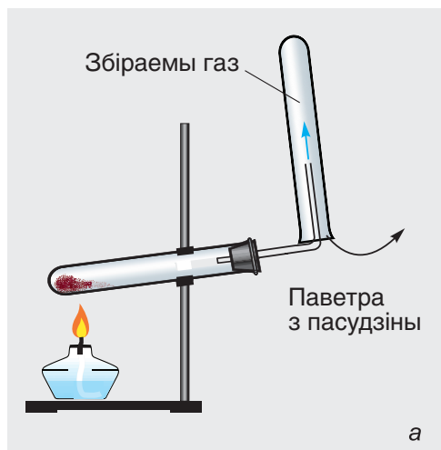
Мал. 45. Схема ўстаноўкі для збірання газаў метадам выцяснення паветра
