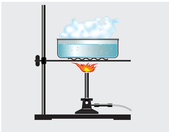
Рис. 15. Выпаривание жидкости
