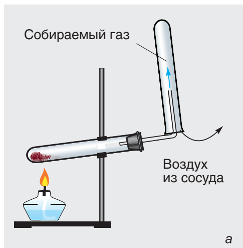
Рис. 45. Схема установки для собирания газов методом вытеснения воздуха
