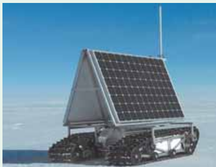
Автономный робот GROVER, который изучает слои льда на ледниковом щите Гренландии.
