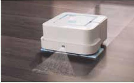
Робот-пылесос с помощью системы камер и сенсоров может ориентироваться в комнате и строить маршрут уборки.
