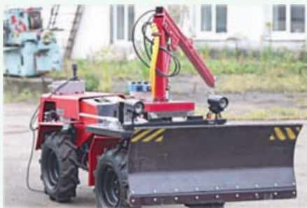
Робот на базе трактора BELARUS-132
