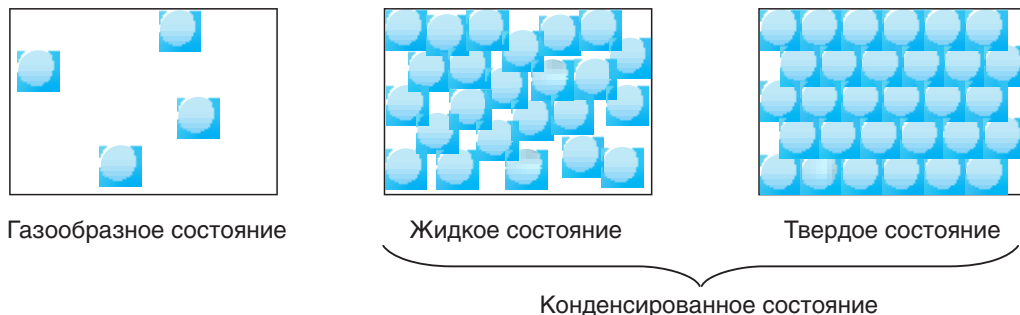
Рис. 10. Схема газообразного и конденсированного состояния веществ
