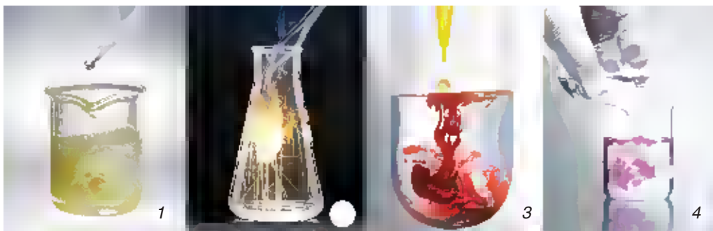
Рис. 2. Признаки химических реакций: 1 — выделение газа; 2 — излучение света и выделение теплоты; 3 — образование осадка; 4 — изменение цвета
