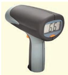
скорость тел, движущихся под водой, а радиолокаторы (радары) — в воздухе и по земле. Сотрудники службы дорожного движения с помощью портативного радара с видеокамерой (рис. 46) регистрируют скорость транспортных средств.
