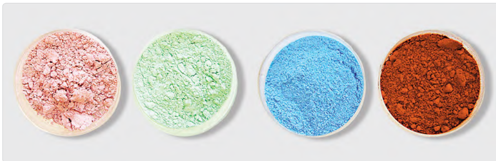
Рис. 139. Окраска гидроксидов некоторых металлов
