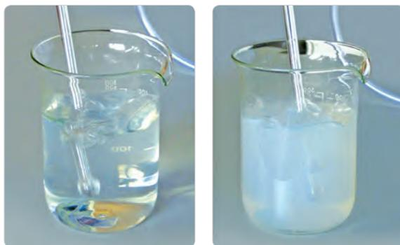
Рис. 94. Взаимодействие углекислого газа с раствором гидроксида кальция
