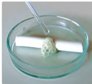
Рис. 96. Взаимодействие карбоната кальция с соляной кислотой
